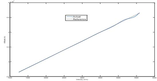
Fig. 4 Reference and actual entry trajectory
