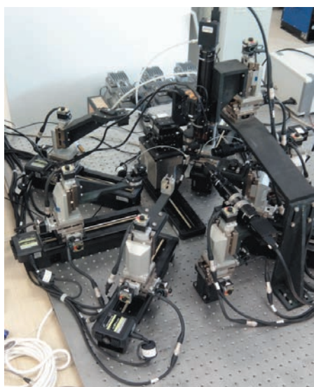
图 3 微装配机器人系统实物图 Fig.3 The micro-assembly robot system
