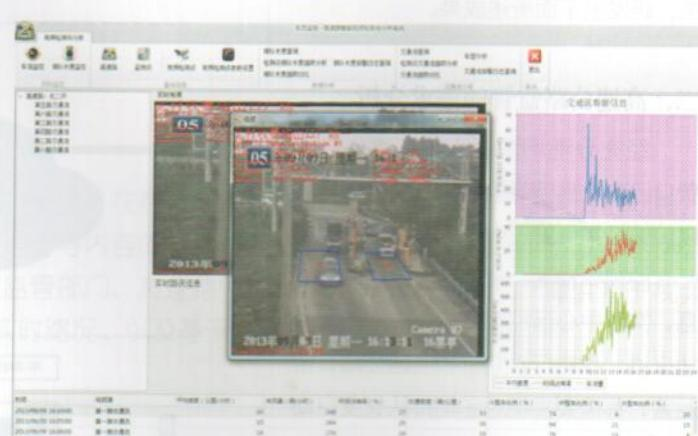
图 3 交通流视频检测示例
