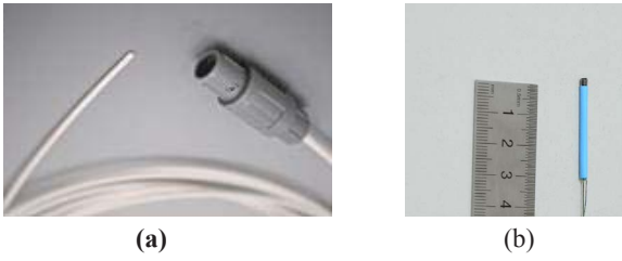
图 4: (a) 6-DOF 导管 (NDI), (b) 装有5-DOF 电磁传感器 (NDI) 的导线。
