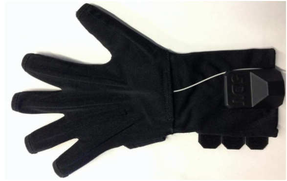
图 6: 增加6-DOF 医用导管 (NDI) 的5DT 数据手套
