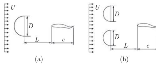
图 7 柔性板运动实验示意图 ((a) 单个 D 形柱; (b) 两个 D 形柱)<sup>[52]</sup>
