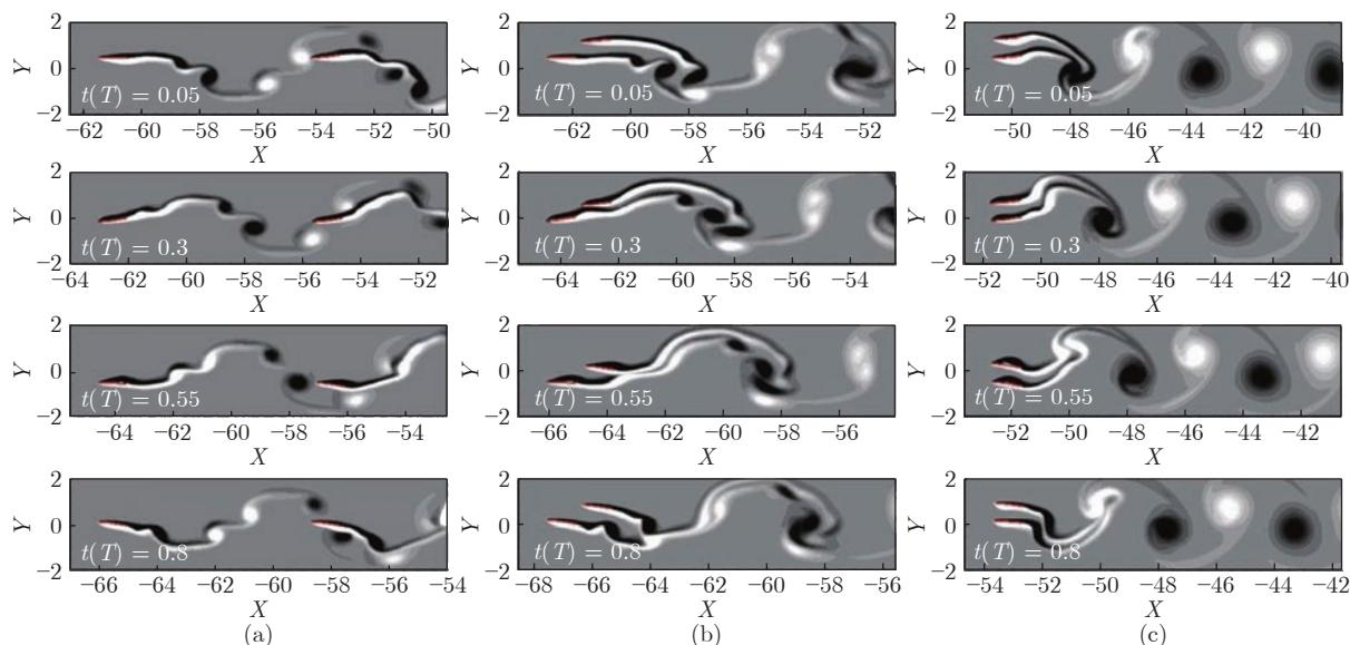
图10 三种前后排列的双鱼编队仿真示意图 ((a) 远距离前后排列; (b) 近距离前后排列; (c) 并行排列)<sup>[68]</sup>
