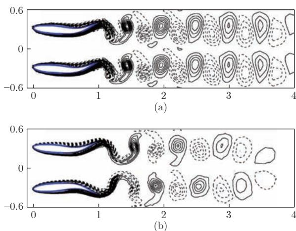
图8 平行排列的波动板运动示意图 ((a) 同相位同步运动; (b) 反相位同步运动)<sup>[65]</sup>
