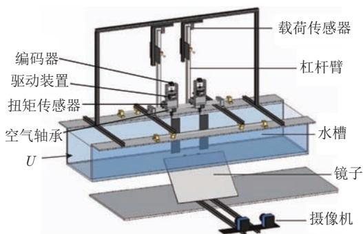
图 12 仿生柔性水翼实验装置<sup>[81]</sup>
