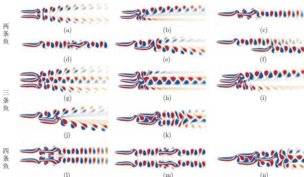
图 11 由两条、三条和四条鱼组成的队列及涡度结构示意图 ((a) 两鱼并排(反相位); (b) 两鱼并排(同相); (c) 两鱼串列(紧凑); (d) 两鱼串列(松散); (e) 两鱼交错(紧凑); (f) 两鱼交错(松散); (g) 三鱼并排(反相位); (h) 三鱼并排(同相); (i) 三鱼梯队; (j) 三鱼交错(I型); (k) 三鱼交错(II型); (l) 四条鱼矩形(紧凑, 反相位); (m) 四条鱼矩形(松散, 反相位); (n) 四条鱼菱形)<sup>[72]</sup>
