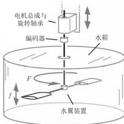
图 13 旋转轨道上扑翼阵推进实验装置<sup>[83]</sup>
