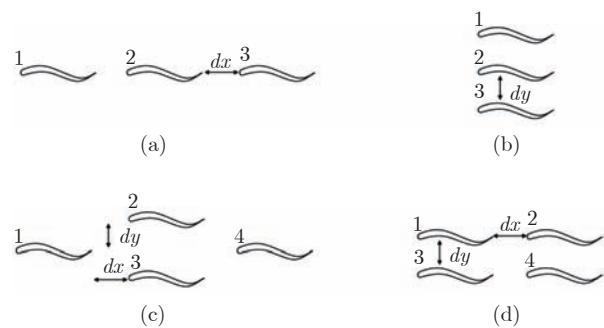
图9 4种集群编队结构的示意图 ((a) 串列; (b) 方阵; (c) 菱形; (d) 矩形。其中相邻点横向间距为  $dy$ , 纵向间距为  $dx$ )<sup>[67]</sup>
