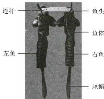
图14 并排链接的两条机器鱼<sup>[85]</sup>Fig. 14 Side by side linked robotic fishes<sup>[85]</sup>
