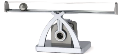
Fig. 1. The actual ball and beam model.
